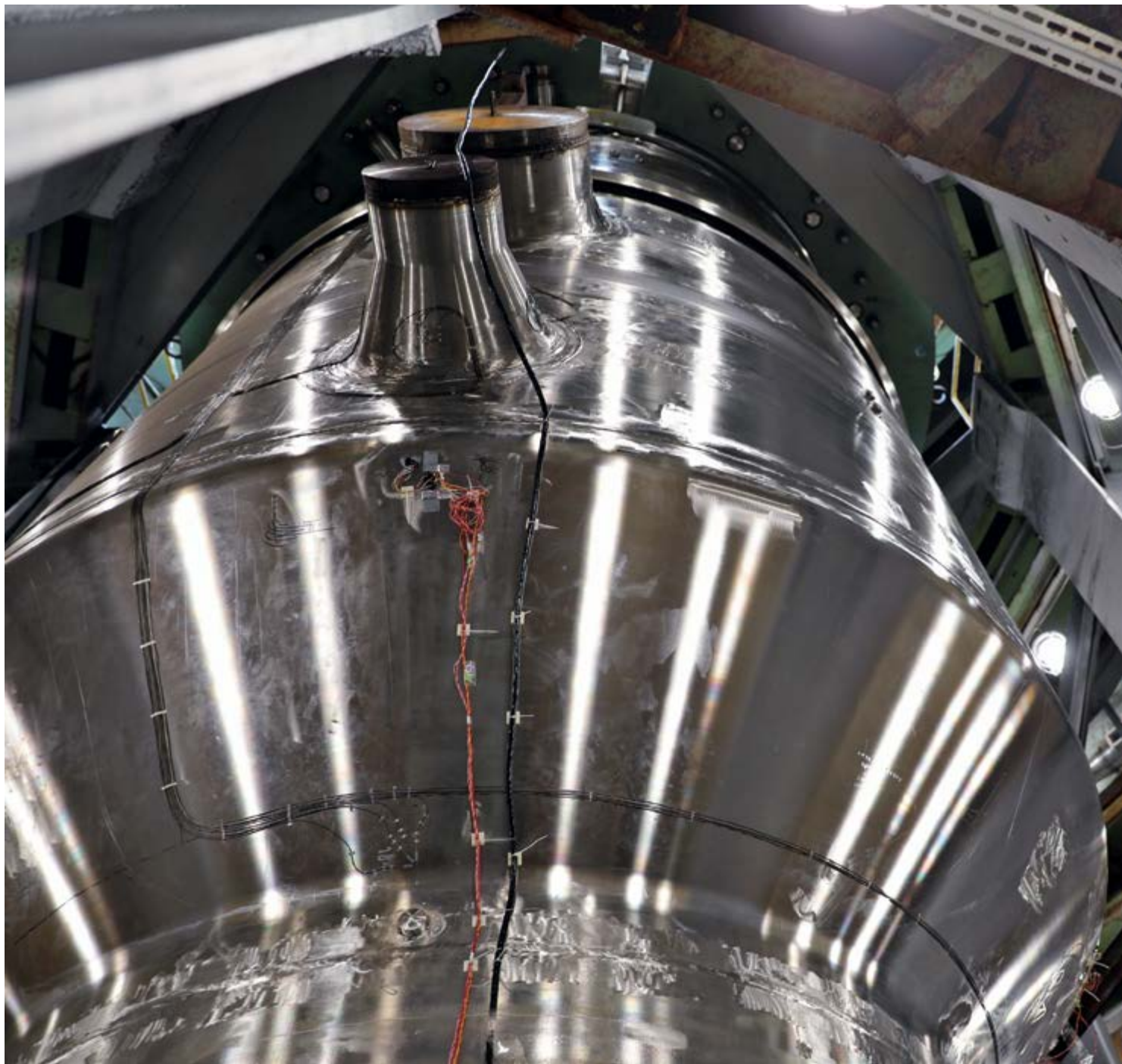
Контрольная сборка исследовательского реактора МБИР на Атоммаше
